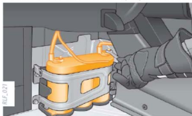
Abb.: Abklemmen des Masseanschlusses (Beispiel Batterie rechts)
