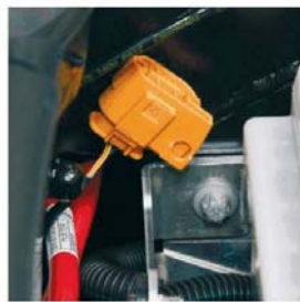
Hochvolt-Rettungstrennstelle geschlossen
