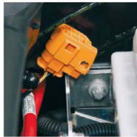
Hochvolt-Rettungstrennstelle geöffnet
